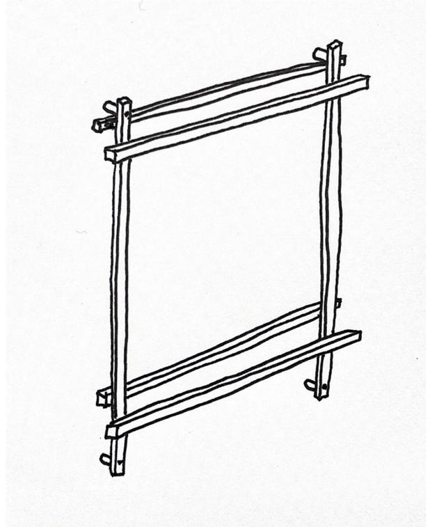
Ensuite des traverses sont placées de part et d'autres des profilés verticaux reserrés par des coleçons qui
